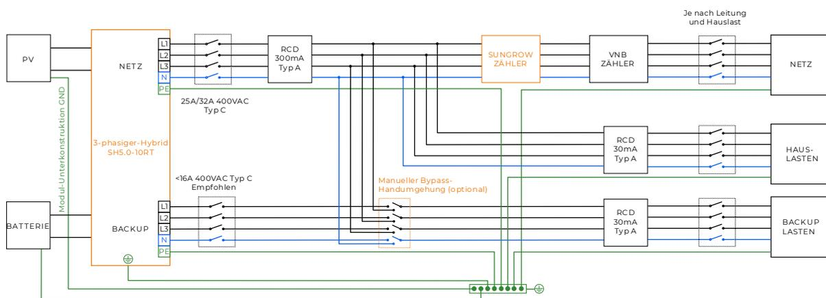
In diesem Fall empfiehlt sich ein 4-poliger Drehschalter wie im nachfolgenden Bild. Position 1 würde beispielsweise die Backup-Lasten mit dem Backup-Port des Wechselrichters verbunden halten, während Position 2 die Backup-Last mit der Hauslast verbinden würde. Der Vorteil dieses Schalters besteht darin, dass der Übergang durch die Stellung 0 (getrennt) einen sicheren Betrieb unter Spannung ermöglicht.
