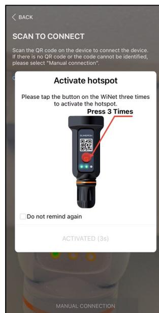
Bitte drücken Sie dreimal die Taste auf dem WiNet-S, um einen WLAN-/Wifi-Hotspot zu erstellen, und verbinden Sie dann Ihr Smartphone-WLAN mit dem WLAN-/Wifi-Hotspot des WiNet-S (der Name beginnt mit SG...). Für neuere Versionen der iSolarCloud geschieht dies automatisch und Sie müssen im Pop-up-Fenster nur auf "Beitreten" oder „Join“ klicken
