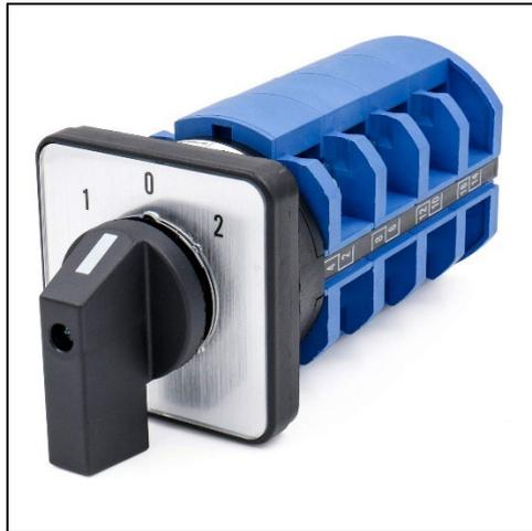
Bevor dieser Schalter betätigt werden kann, muss beim Umschalten der Backup-Lasten auf die Hauslasten der Hybrid Wechselrichter ordnungsgemäß heruntergefahren werden, danach der bauseitige Sicherungsautomat am 3-phasigen Hybrid Backup-Anschluss manuell ausgelöst werden und zuletzt ggf. der Backup-Anschlussstecker abgezogen werden.
